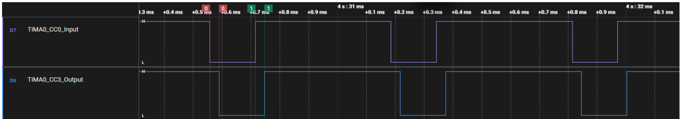
図 5-3. 入力換算により固定遅延を含めて生成された PWM 信号
