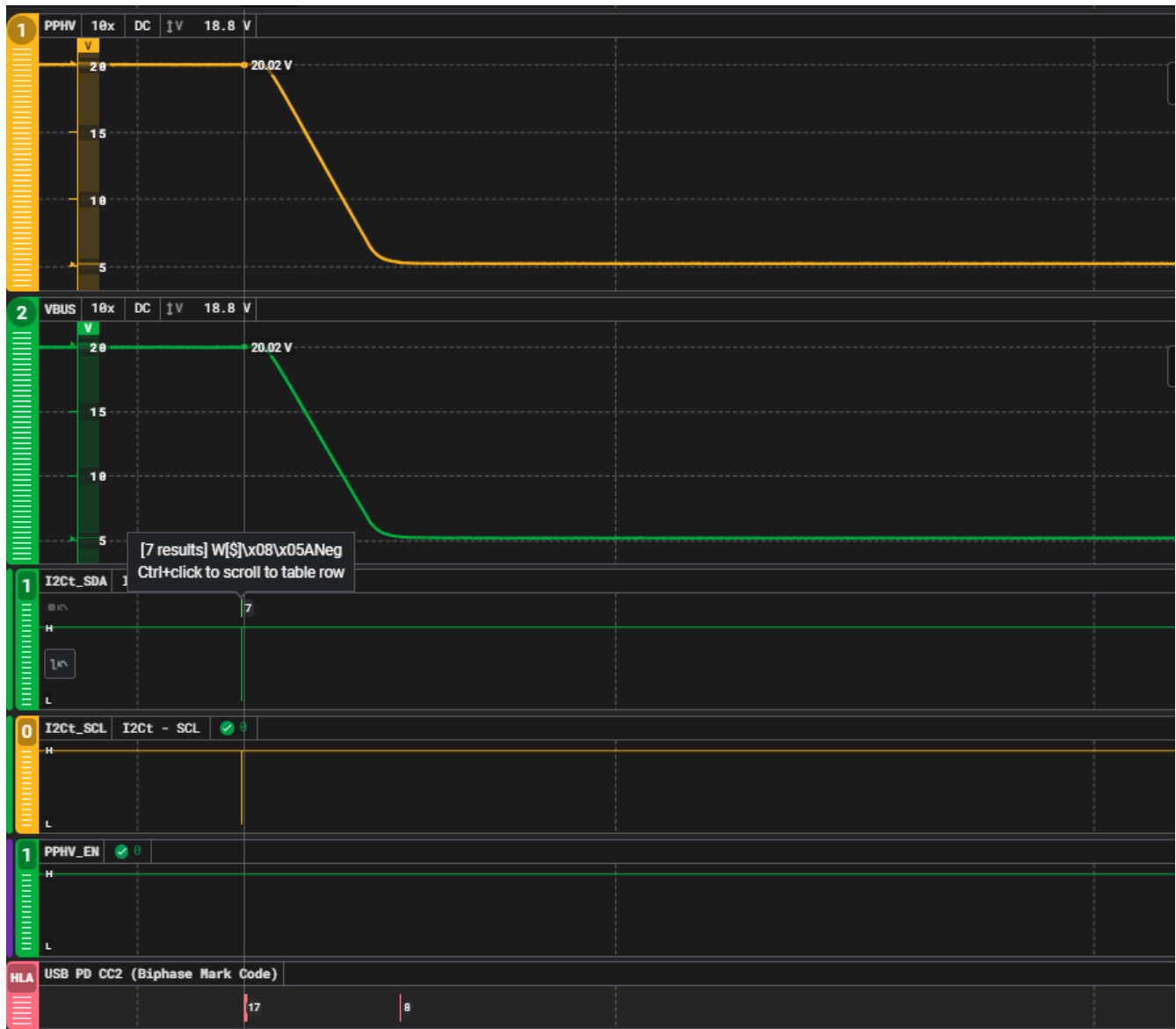
図 6-3. 4CC「ANeg」コマンドが送信され、USB-PD が 5V に低下
