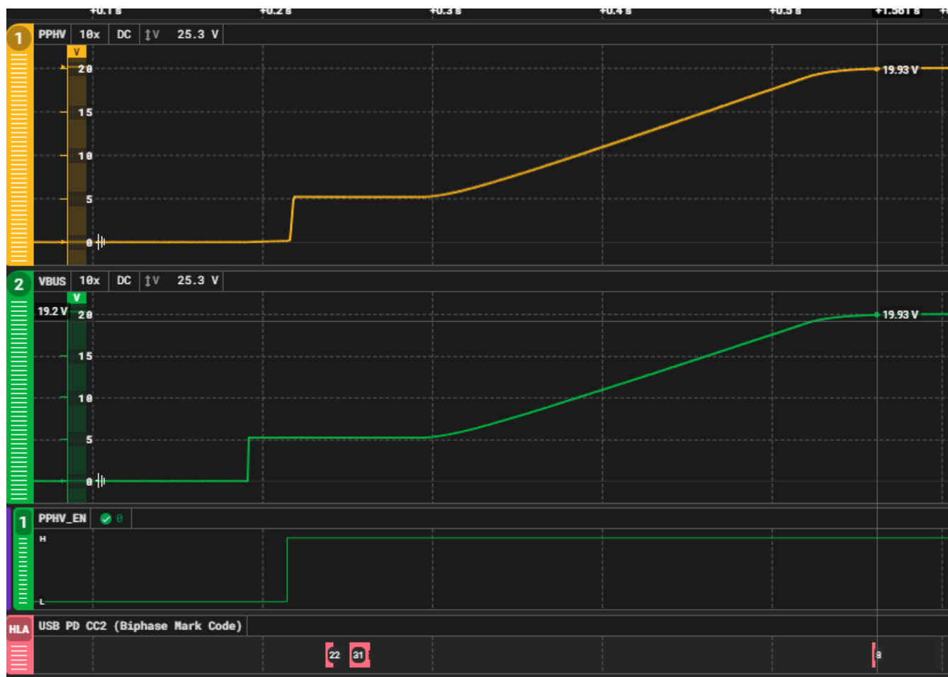
図 6-1. 20V USB-PD ソースから TPS25751 への接続
