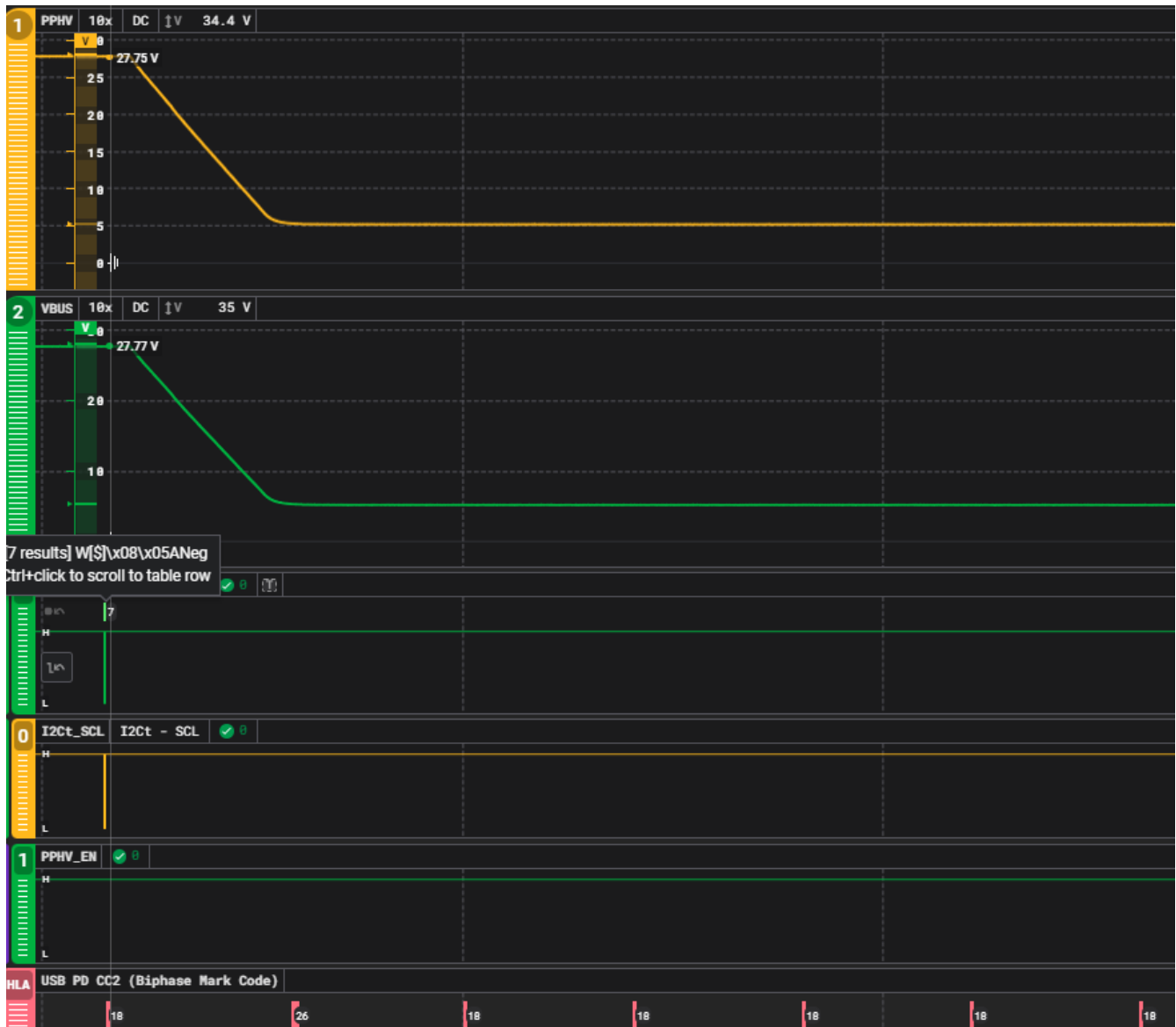
図 6-4. 4CC「ANeg」コマンドが送信され、USB-PD が 5V に低下
