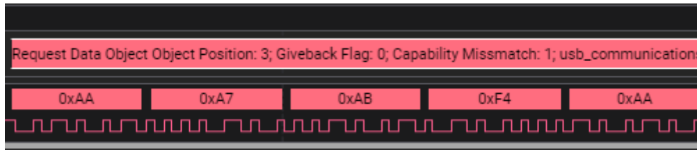
図 3-4. PD デバイスから PD ソースへのリクエスト データ オブジェクト
