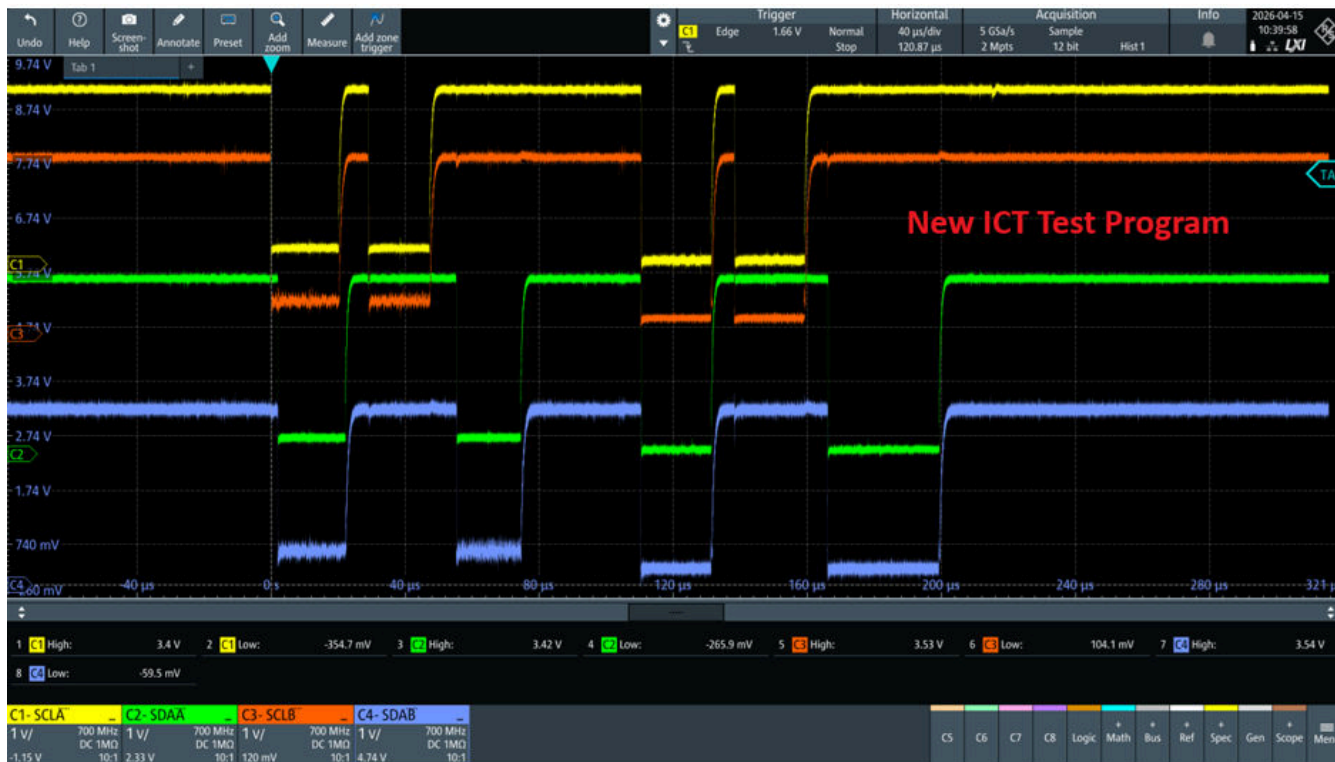
図 2-4. ソフトウェアおよびハードウェアを変更した新しい ICT 設定では、オーバーシュート/アンダーシュート動作が軽減され、B 側ペDESTALの競合が解消されます
