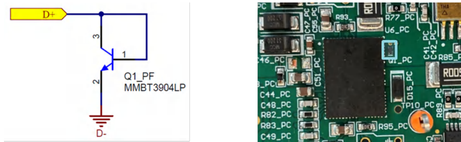
図 3-5. TPS7H6101-SEP 電力段デバイスの近くに配置したダイオード構成の BJT を使用した、小型でコスト効率に優れた温度モニタの実装
