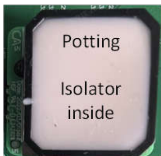
図 5-3. 固体絶縁体を達成するためのポッティング方法
