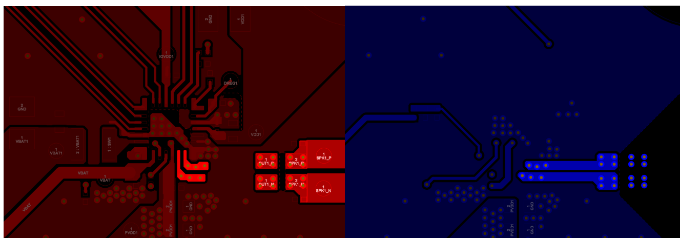
図 3-12. 上面 (赤) および下面 (青) 層 — 出力接続(ソフトウェア制御)
