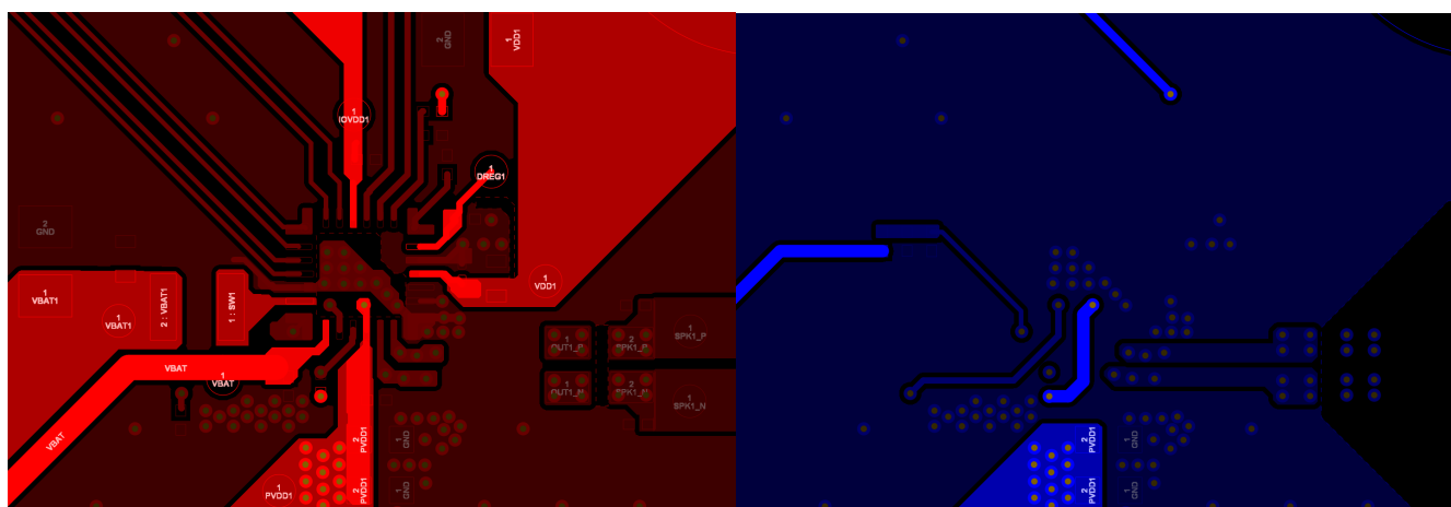
図 3-11. 上面 (赤) および下面 (青) 層 — 電源接続(ソフトウェア制御)
