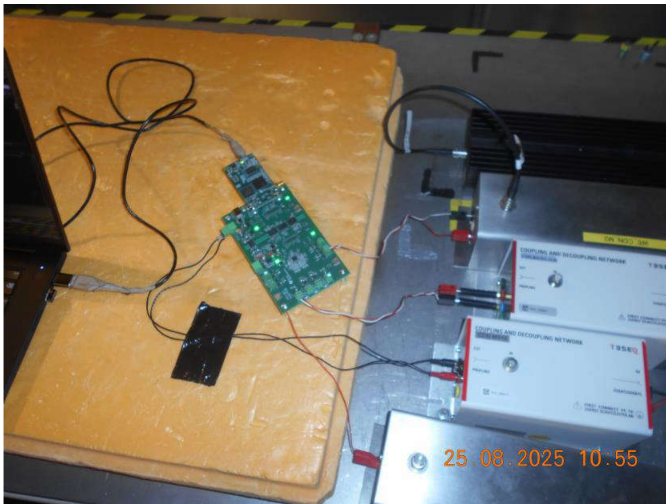
図 3-15. CI テストのラボ設定
