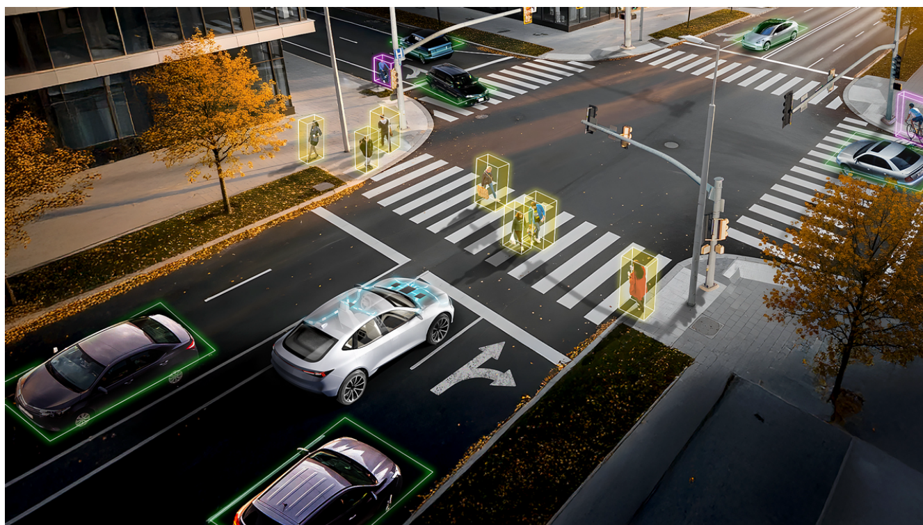
図 1. 環境データを分析するソフトウェア定義車両における自動運転のための ADAS 機能の可視化
