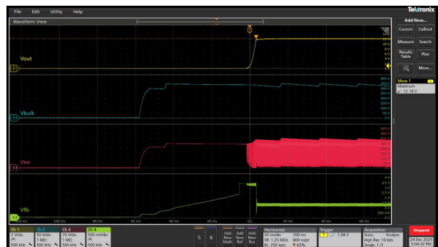
図 3-13. 全負荷時における 12V 出力の起動波形
