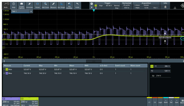
図 3-64. 230Vac 入力時の 2KV サージ
