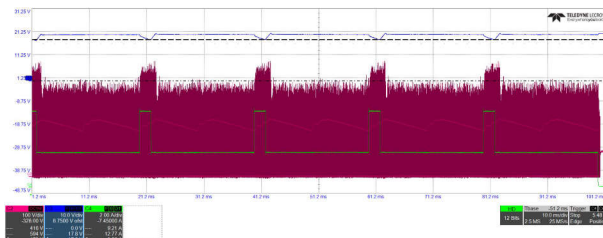
図 3-68. VIN = 90Vac (2 x 定格電流が 2ms 間、0.9 x 定格電流が 18ms 間)
