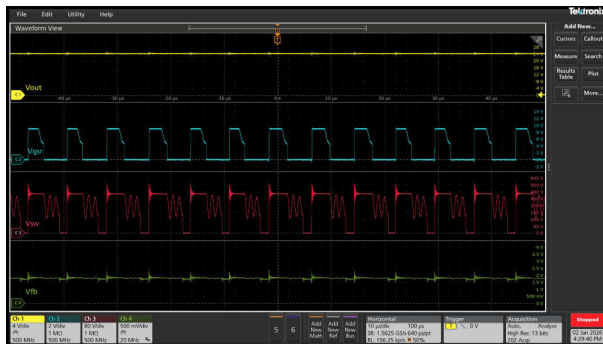
図 3-32. V_{in} = 230\text{Vac} 、 V_{out} = 24\text{V}
