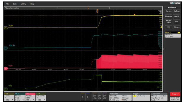
図 3-11. 全負荷時における 24V 出力の起動波形
