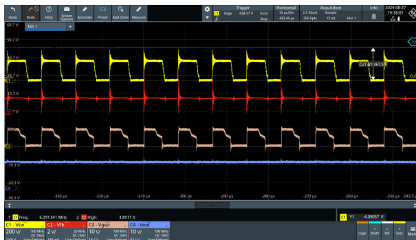
図 3-18. Vin = 90Vac、Vout = 15V
