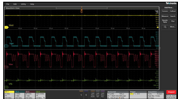
図 3-33. V_{in} = 264\text{Vac} 、 V_{out} = 24\text{V}
