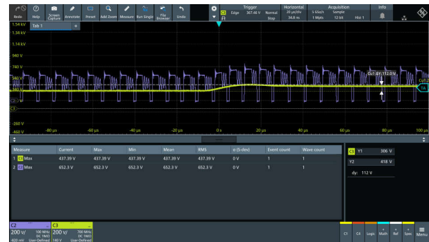
図 3-65. 230Vac 入力時の 1KV サージ
