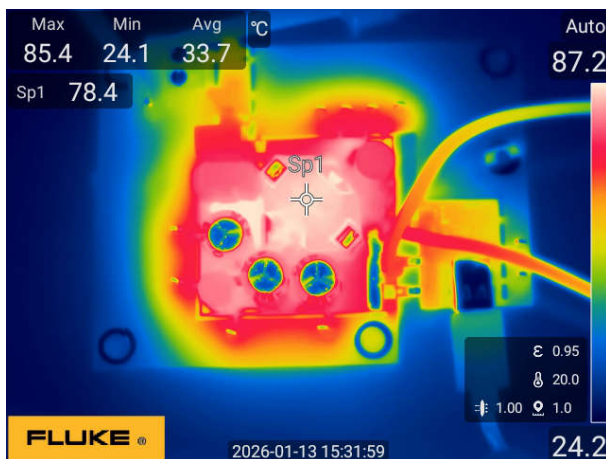
図 3-72. V_{IN} = 115V_{AC} 、上面
