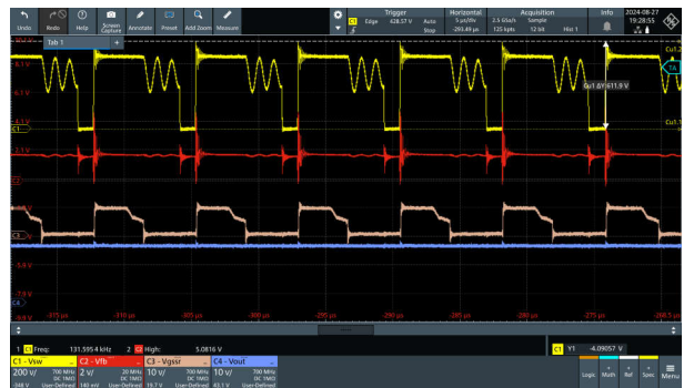
図 3-17. Vin = 264Vac、Vout = 20V
