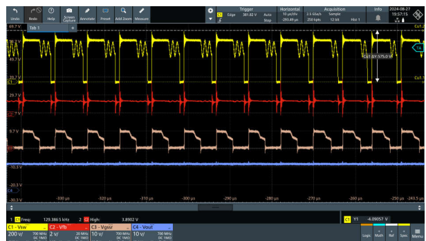
図 3-21. Vin = 264Vac、Vout = 15V
