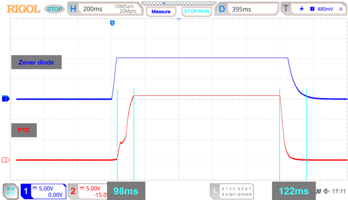
図 4-30. 30V 過電圧時の電流入力モードで測定された保護応答
