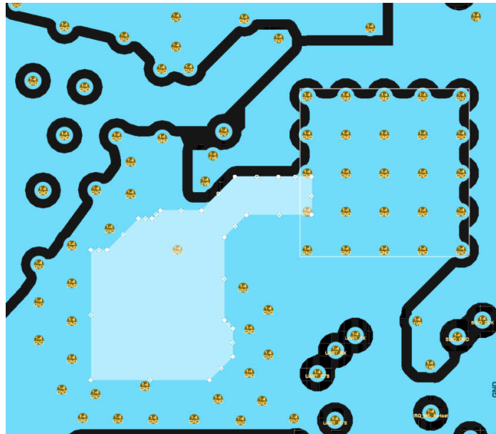
図 3-15. XTAL カットアウト下層のリファレンス レイアウト
