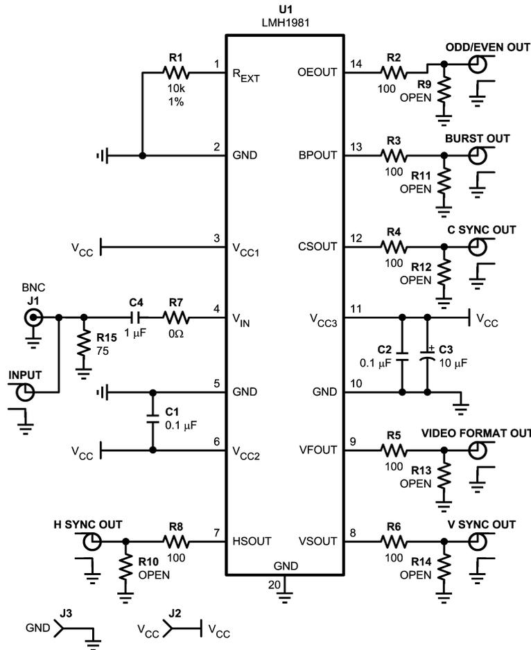
SD コンポジット・ビデオを入力する場合、特に・レベルがシンク・レベルの 50% 以下に下がり、しかもフロント・ポーチ近くにまで達する場合、あるいは全体の信号対雑音比を改善する必要がある場合には、RC ローパス・フィルタの使用を推奨します。
