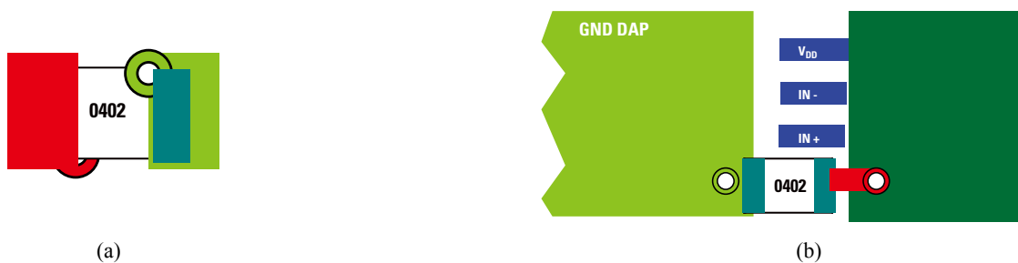
図 5-8a と 5-8b. デカップリング・コンデンサの配置例
