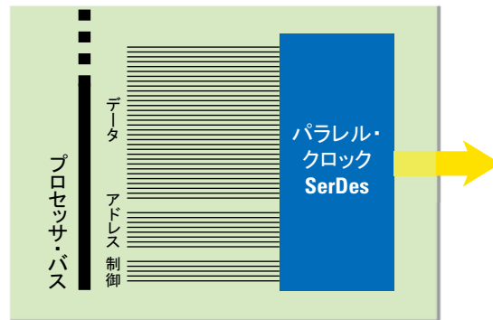
図 3-7. アドレスと制御線とデータ信号で構成される従来の広いパラレル・バスを収容するパラレル・クロック SerDes
