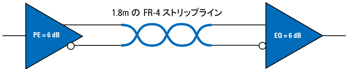
図 7-20. 6dB PE に設定した出力プリアンプ・デバイスから 1.8m トレースを介して -6dB EQ に設定した入カイコライゼーション・デバイスを駆動した例
