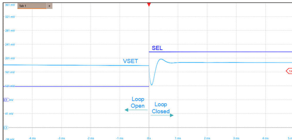
図 3. 出力波形: 正の SEL 遷移の拡大図
