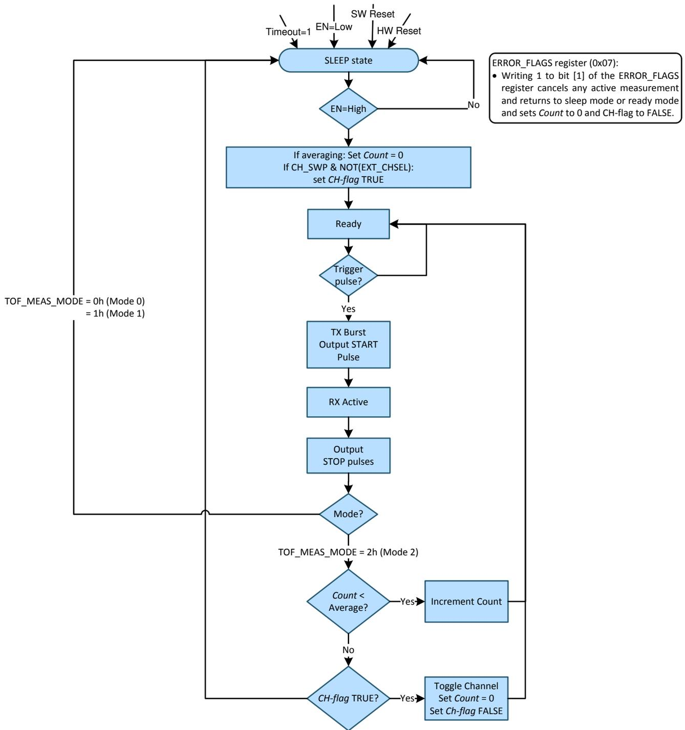
図 8-14. TDC1000 のステート・マシンの概略図
