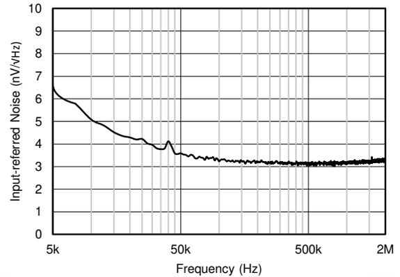
$V_{DD} = V_{IO} = 3.7V$  ゲインが 21dB のとき  $R_L = \infty$
