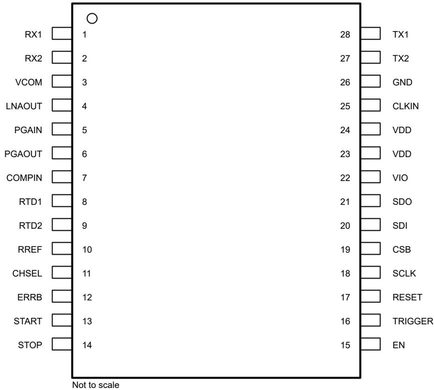
図 5-1. PW パッケージ 28 ピン TSSOP 上面図
