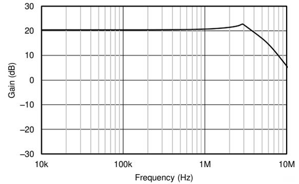
$V_{DD} = V_{IO} = 3.7V$     ゲインが 21dB のとき     $R_L = 100k\Omega$
