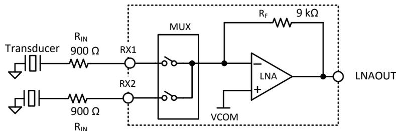
図 8-3. LNA の抵抗性帰還の構成
