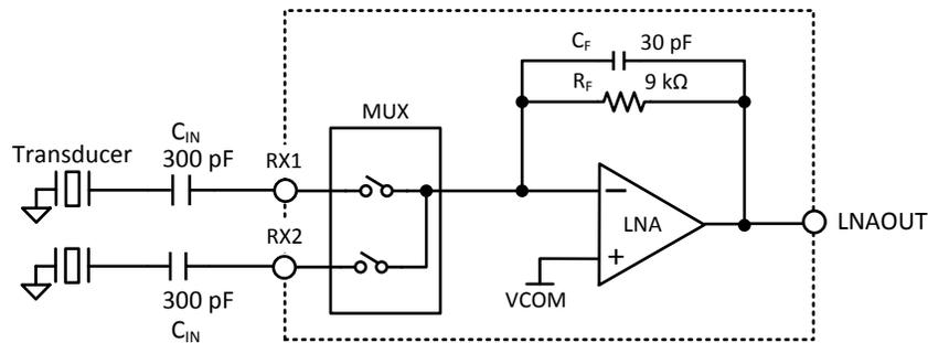
図 8-2. LNA の容量性帰還の構成
