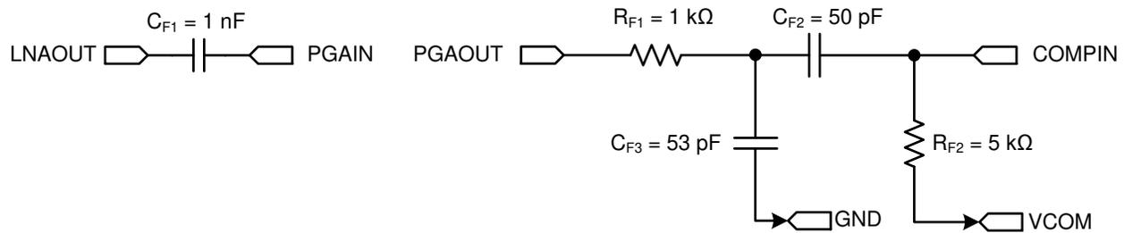
図 8-5. 1MHz 動作用のフィルタ
