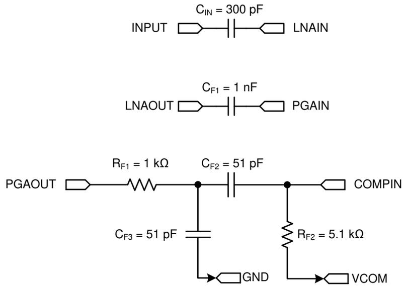
図 7-1. ジッタ測定用の外部回路
