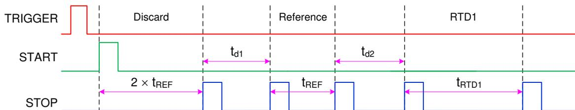
図 8-13. 単一の PT500 による温度測定
