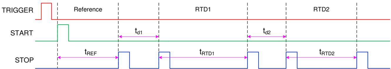
図 8-11. 温度測定の出力タイミング
