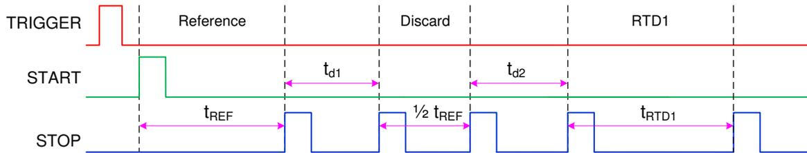
図 8-12. 単一の PT1000 による温度測定
