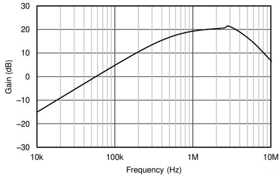
$V_{DD} = V_{IO} = 3.7V$     容量性フィードバック     $R_L = 100k\Omega$
