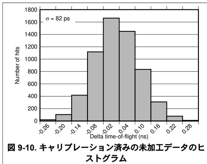
図 9-10. キャリブレーション済みの未加工データのヒストグラム
