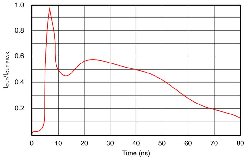
図 4. IEC61000-4 ESD Test Pulse
