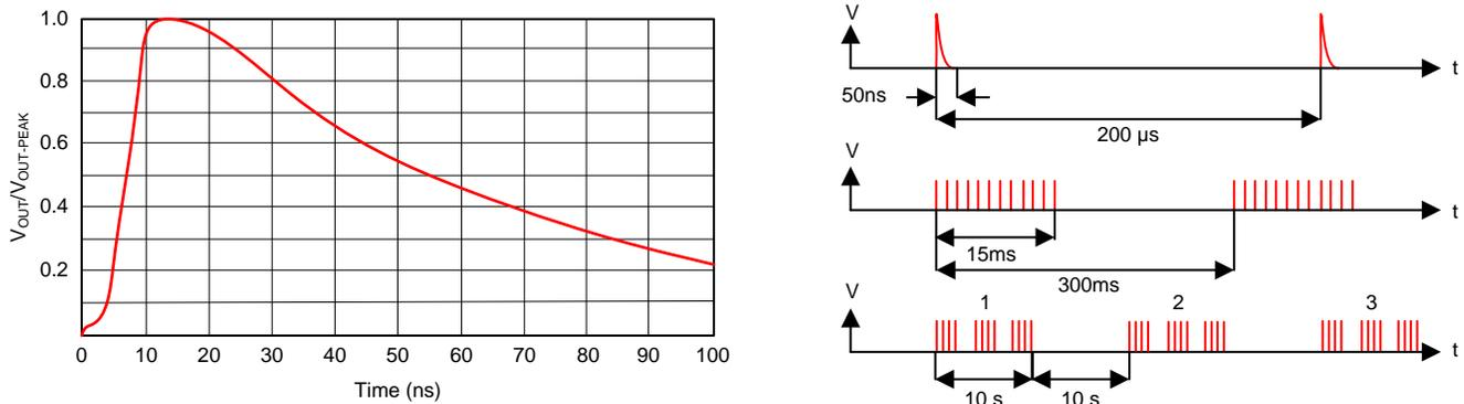
図 5. IEC61000-4-4 EFT Test Pulses
