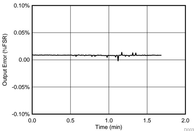
図 13. Current Output:  $\pm 15$ -kV ESD Air Discharge
