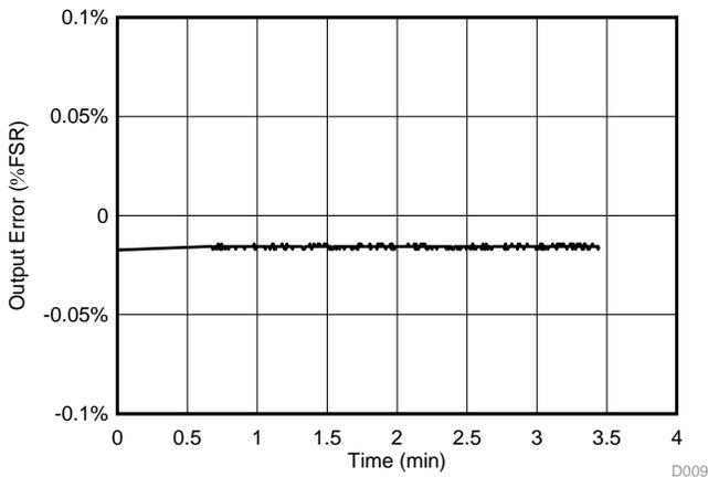
図 11. Voltage Output:  $\pm 15$ -kV ESD Air Discharge
