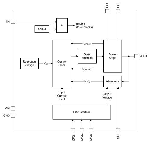
図 2-7. TPS63900 Functional Block Diagram
