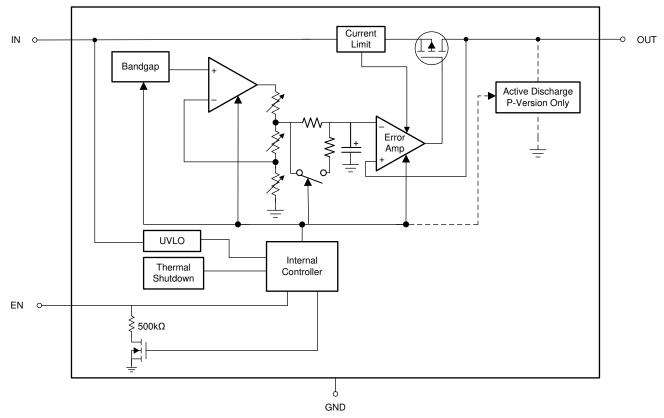
図 2-10. TPS7A20 Functional Block Diagram
