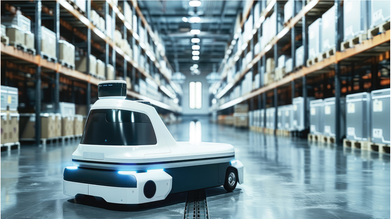
그림 1. LiDAR를 사용하여 탐색하는 AMR
