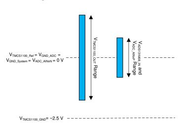
Figure 3-5. V<sub>ADS131M08\_IN</sub> Voltage Range
