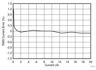
Figure 5-5. RMS Current B % Error
