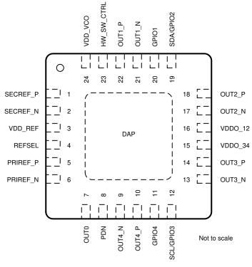
Figure 4-1. Pin Diagram
