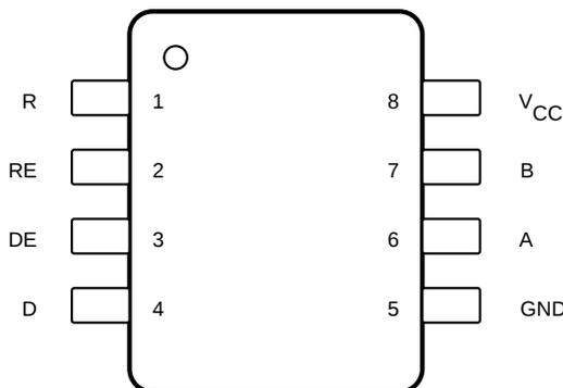
**Figure 4-1. Pin Diagram**
