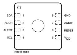
Figure 4-1. Pin Diagram
