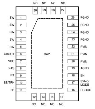
Figure 4-1. Pin Diagram
