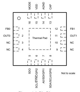
Figure 4-1. Pin Diagram
