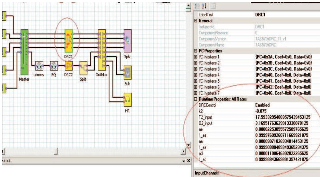
Figure 12. DRC Parameters
