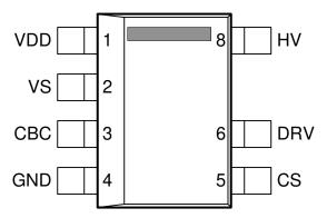
Figure 4-1. Pin Diagram
