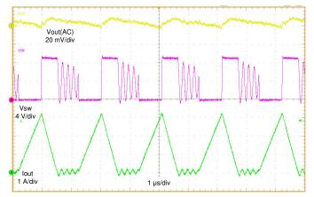
Power Vin = Signal Vin = 3.6 V, Vo = 9 V, Io = 0.2 A
