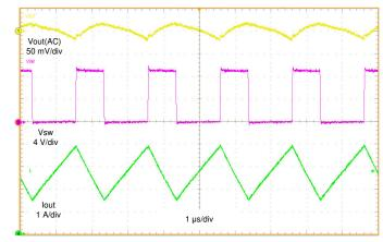
Power Vin = Signal Vin = 3.6 V, Vo = 9 V, Io = 1 A
