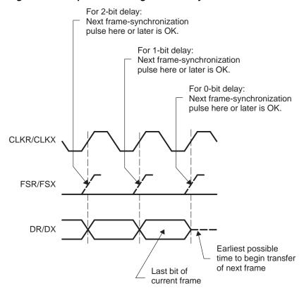
Figure 4-5. Proper Positioning of Frame-Synchronization Pulses
