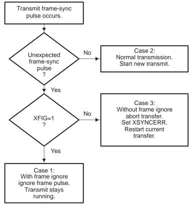
Figure 4-9. Possible Responses to Transmit Frame-Synchronization Pulses
