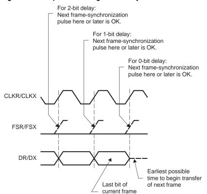
Figure 4-11. Proper Positioning of Frame-Synchronization Pulses
