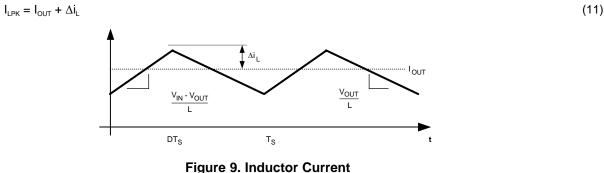
$$\frac{V_{\rm IN} - V_{\rm OUT}}{L} = \frac{2\Delta i_L}{DT_{\rm S}}$$
