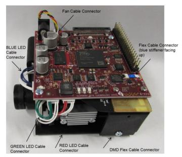
Figure 3-6. DLP<sup>®</sup> LightCrafter<sup>™</sup> Display 230NPEVM
