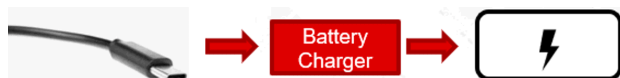
図 5. 240W の USB 電源でポータブル電源ステーションのバッテリーを充電
