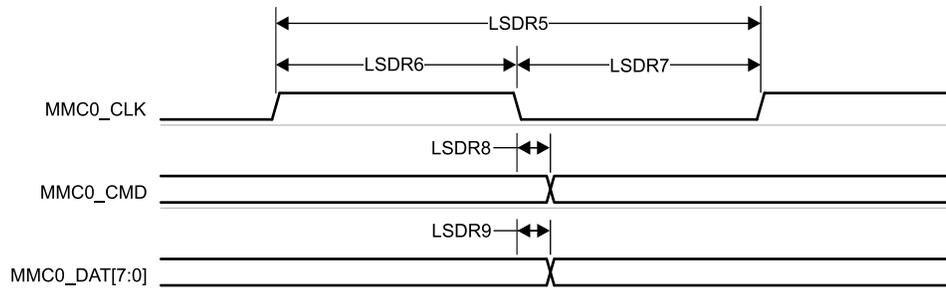
Figure 6-68. MMC0 – Legacy SDR – Transmit Mode
