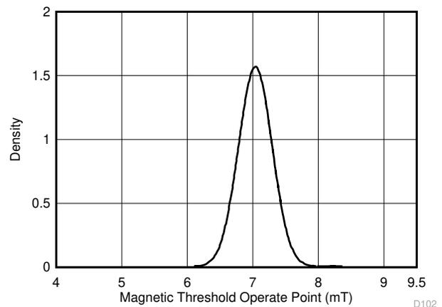
$T_A = 25^\circ\text{C}$ ,  $V_{CC} = 1.65\text{ V to } 5.5\text{ V}$
