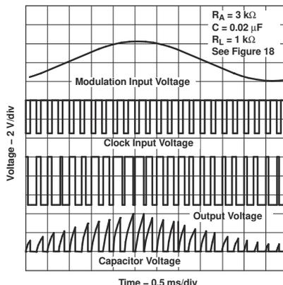
**Figure 7-4. Pulse-Width-Modulation Waveforms**
