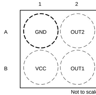
Figure 5-2. YBK Package 4-Pin DSBGA (Dual-Unipolar) Top View
