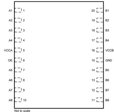
Figure 4-2. DQS Package (Top View)
