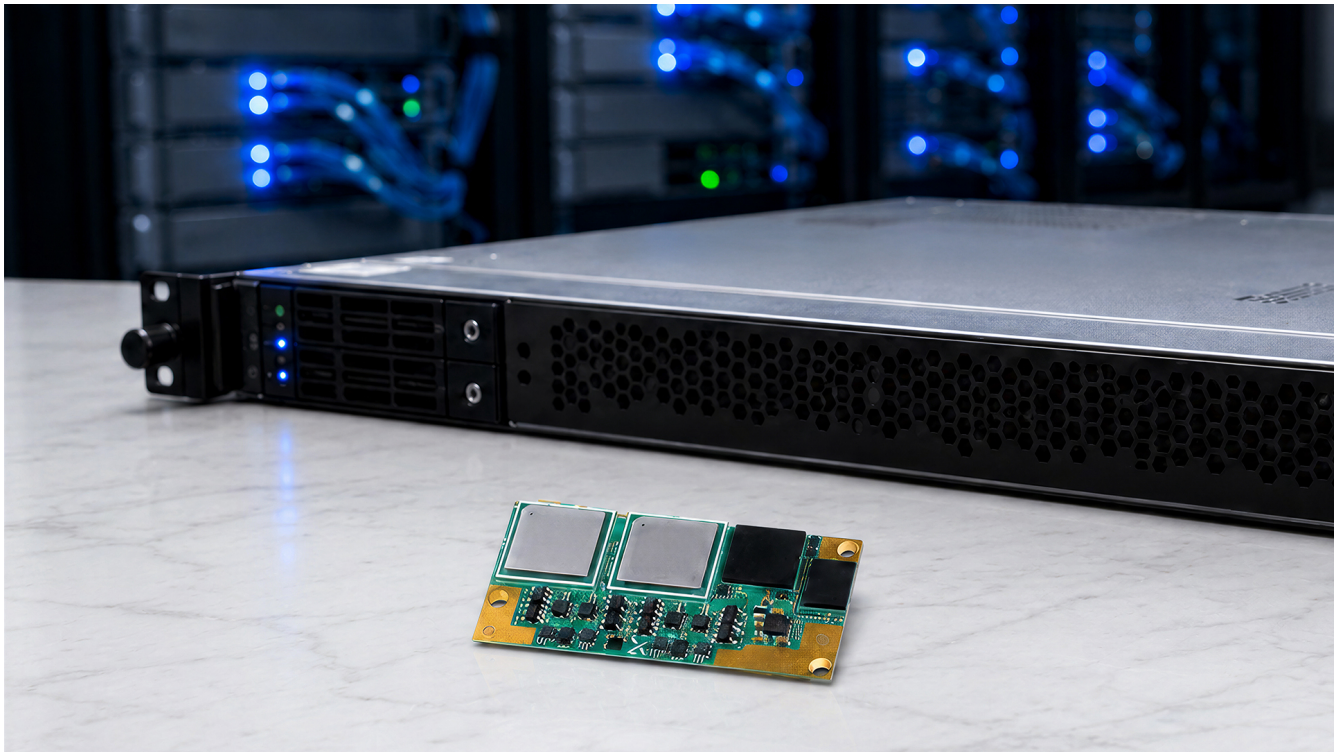
그림 3. 프로세서 내부의 8개 전압을 나노초 분해능으로 측정하는 TI의 8채널 SOM
