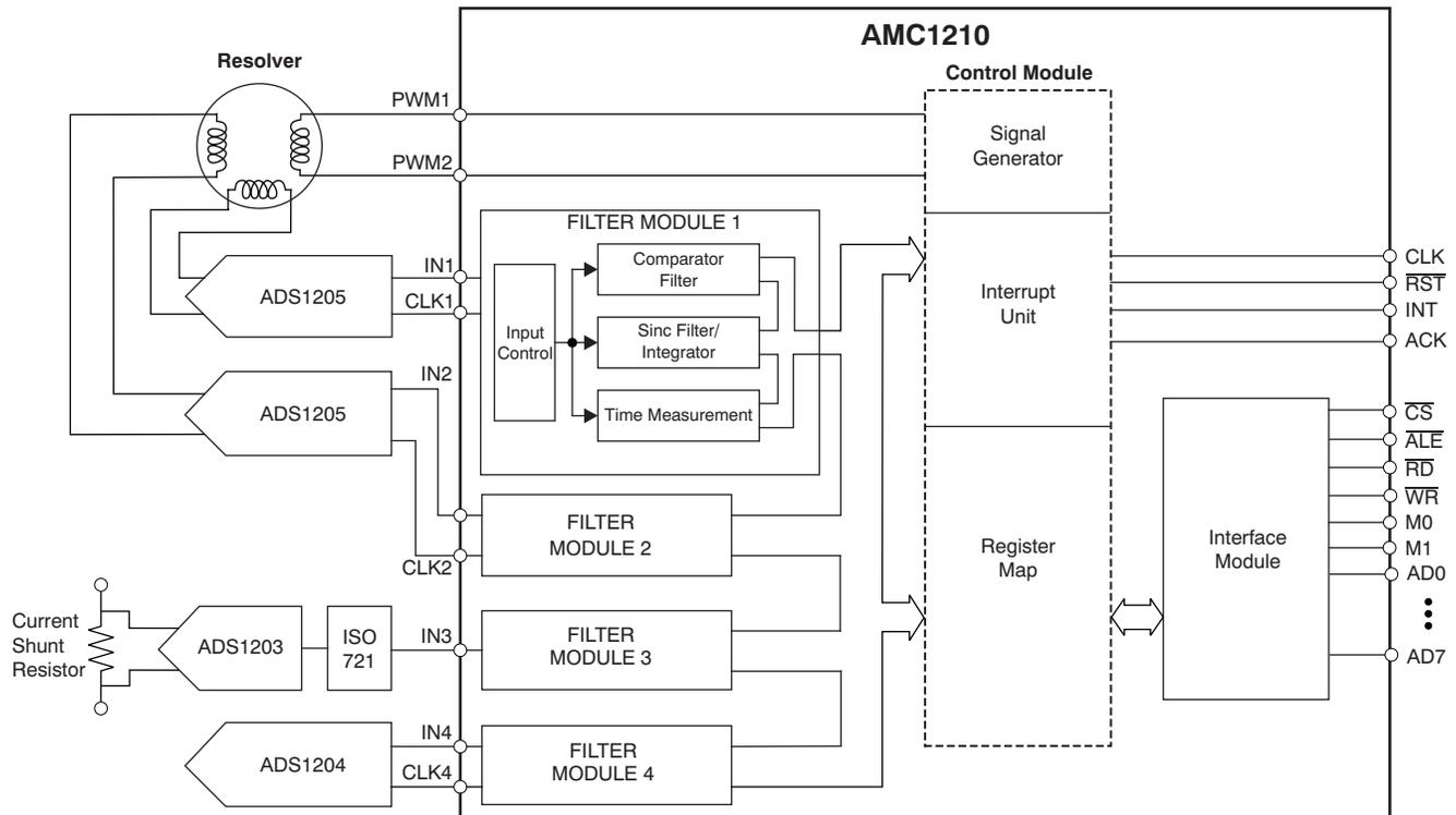
**Figure 2. AMC1210 Block Diagram**
