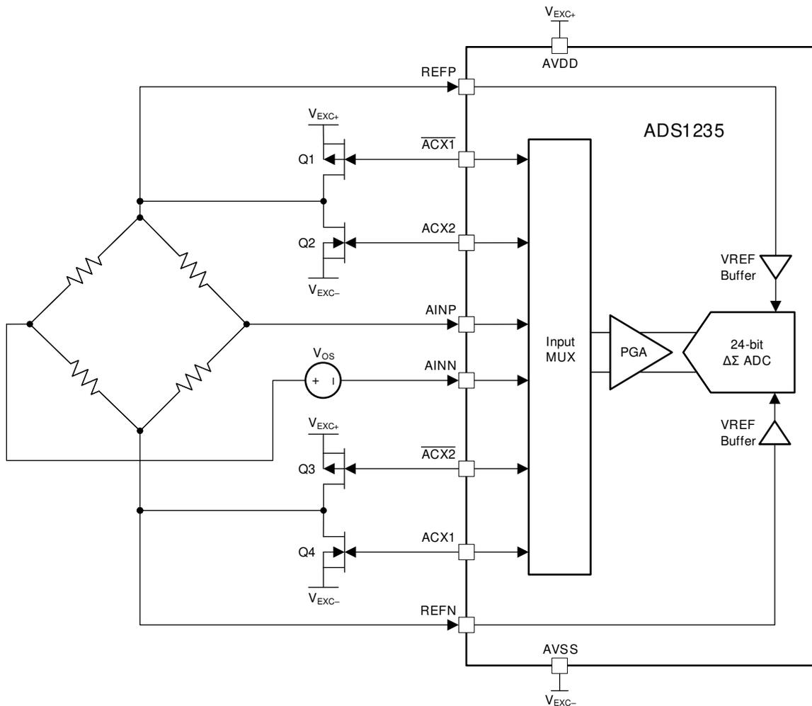
**Figure 2. Four-Wire AC Excitation Circuit Using ADS1235**
