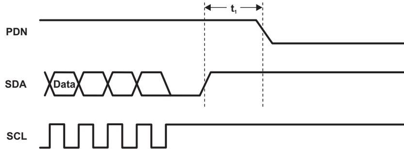
Figure 1. Powerdown Timing
