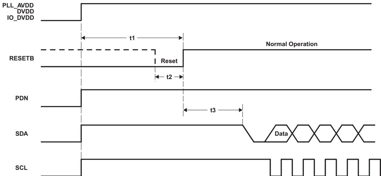
Figure 2. Power-On Reset Timing
