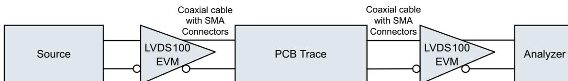
Figure 11. SN65LVDS100/PCB Trace Test Setup
