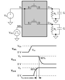
Figure 7-4. Make-Before-Break Time
