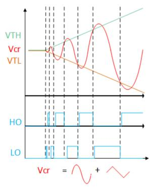
Figure 3. Soft-Start Switching
