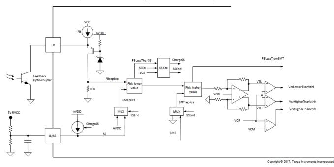
Figure 1. Soft-Start Block Diagram
