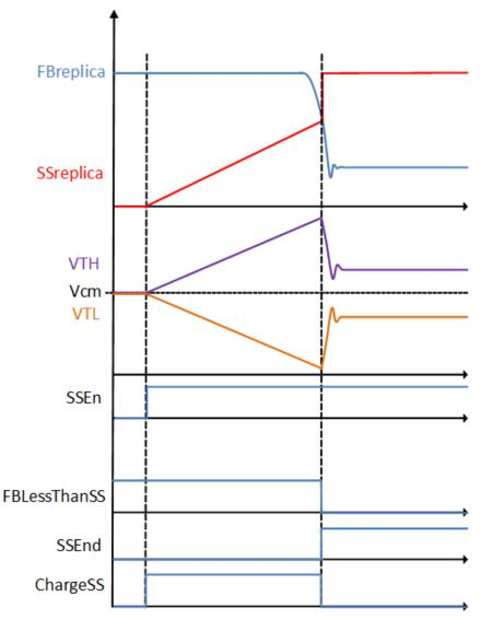
Figure 2. Soft-Start Waveforms
