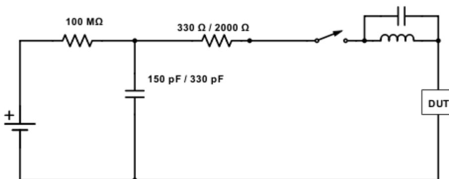
**Figure 2-1. ISO 10605 Equivalent Circuit**
