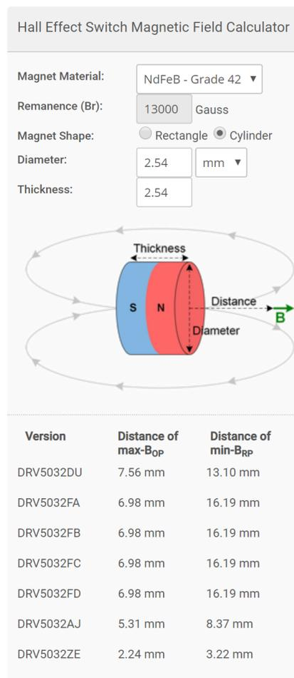
**Figure 3. TI Magnetic Calculator Results for DH1H1**
