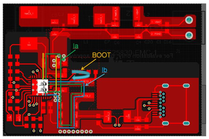
Figure 8. TPS2583X PCB Layout
