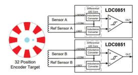
Figure 4-1. Incremental Encoder (TIDA-00828)
