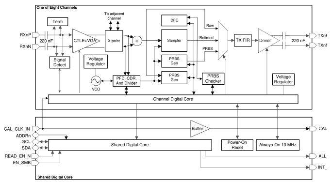
Figure 1-1. DS280DF810 Retimer Functional Block Diagram
