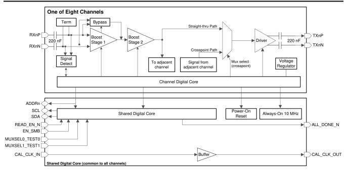
Figure 1-2. DS280MB810 Redriver Functional Block Diagram
