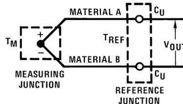
$$V_{\text{OUT}} \approx \alpha(T_M - T_{\text{REF}})$$
