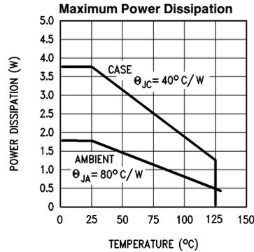
FIGURE 14. Power Dissipation
